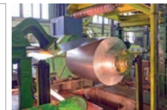
Inline-Schichtdickenmessung auf Stahlbändern, z.B. Cu/Fe
