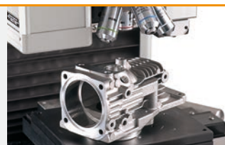
Mikrohärtebestimmung an einem Getriebegehäuse
