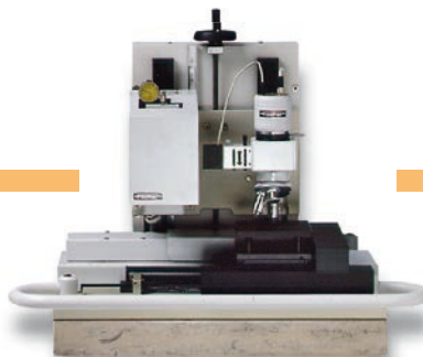
1999 FISCHERSCOPE® H100 C: Neues Design, verbesserte Abstandsmessung, höhere Kraftauslösung, Integration einer XY-Ansteuerung, neue Software
