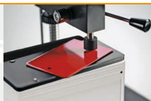
Bestimmung der mechanischen Eigenschaften von Lackschichten
