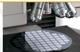
Automatisierte Messungen auf einem Wafer
