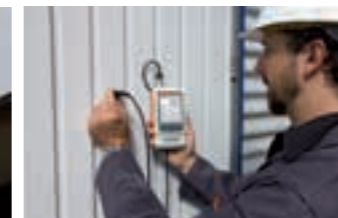
Messung einer Lackschicht auf Stahl
