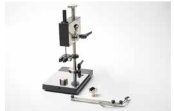
Stativ zum Einspannen von Innensonden
