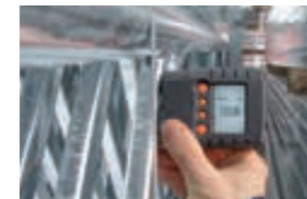
Messung von Eloxal auf Aluminiumrahmen für Gebäudeverkleidung
