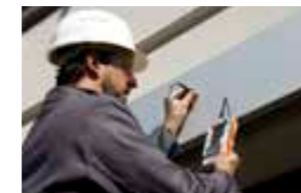
Messung von Eloxal auf Aluminium an einer Fassade
