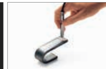
Ferritgehaltmessung im Schweißnahtbereich
