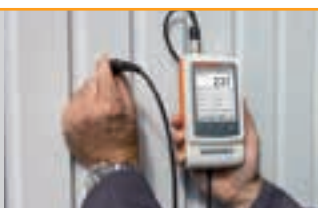
Lackschichtdickenmessung auf Stahl
