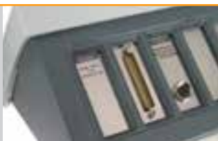
Rückseite des MMS PC2. Acht Modulplätze sind verfügbar.
