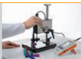
Messung mit Stativ auf gekrümmten Eloxalteilen
