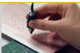
Messung der Kupferschichtdicke auf Leiterplatten
