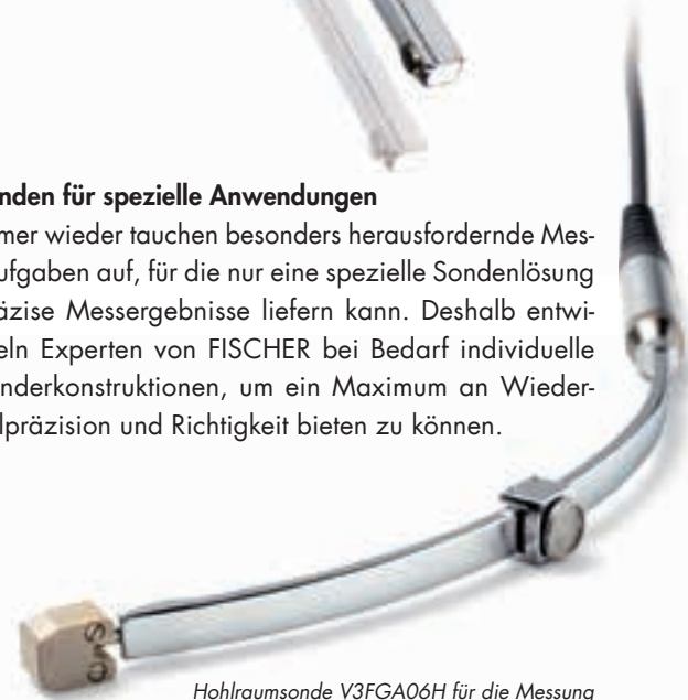
Hohlraumsonde V3FGA06H für die Messung von KTL-Beschichtungen in schwer zugänglichen Hohlräumen. Dadurch wird die Zerstörung z.B. von Karosserieteilen hinfällig
