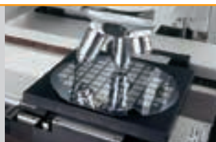
Wafer: Härtebestimmung an der Goldbeschichtung
