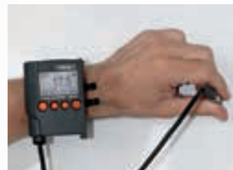
Handgelenkschalter für MPOR-FP Geräte zur Einhandbedienung
