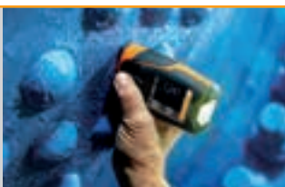
MMS® INSPECTION DFT: Messungen von dicken Schichten
