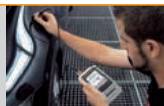
Lackschichtdickenmessung mit der Dual-Sonde FD13H
