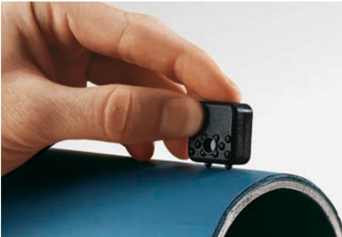
Messung der Kunststoff-Korrosionsschutzschicht auf Stahlrohren mit der Sonde FKB10.
