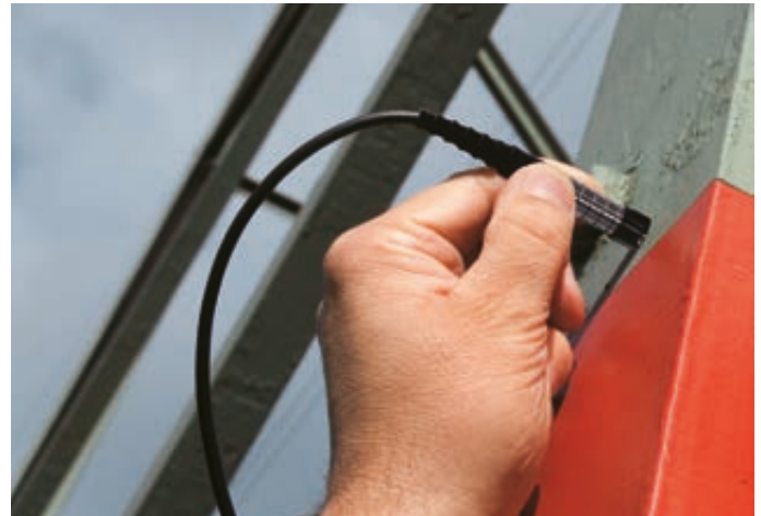
Duplex-Messung der Lack-/Zinkschichten mit der Sonde FDX13H.
