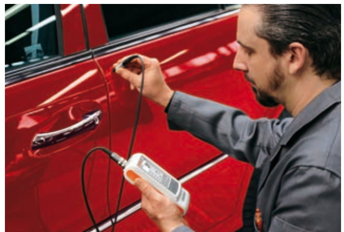
Lackschichtdickenmessung an einer Karosserie mit der Dual-Sonde FD10.
