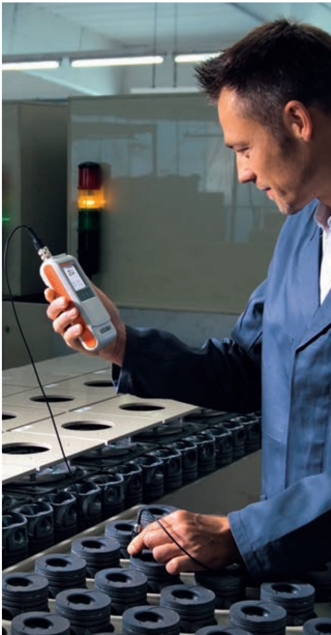
Qualitätsüberwachung an Motorkolben nach dem Ferti-gungsprozess mit der Sonde FTA3.3H.
