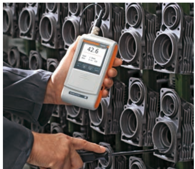
Messung mit der Innensonde FAI3.3-150.
