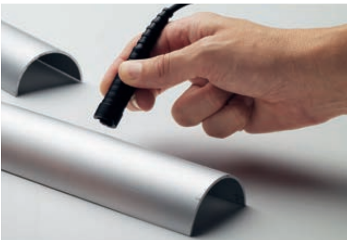
Messung der Eloxalschicht mit der krümmungskompensierten Sonde FTD3.3.
