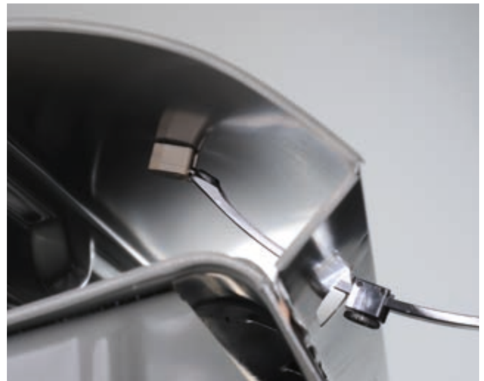
Schnitt durch ein Karosserieteil, um die Messung der KTL-Beschichtung mit der Sonde V3FGA06H zeigen zu können.
