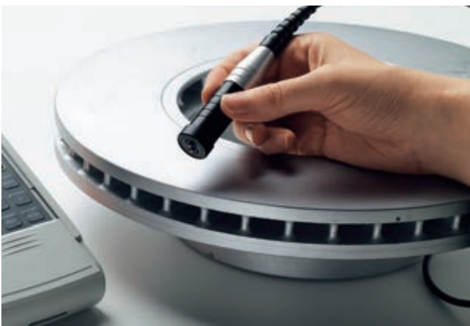
Messung der Zinkstaub-Schicht mit der Zweipolsonde V7FKB4.
